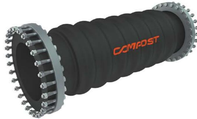
AS COMPARED TO A SINGLE EXPANSION JOINT, A MULTI LENS EXPANSION JOINT HAS A LARGER COMPRESSION AND TENSION AMPLITUDE HELPING REDUCE THE NUMBER OF SUCH JOINTS REQUIRED FOR LONG LINE SECTIONS.
